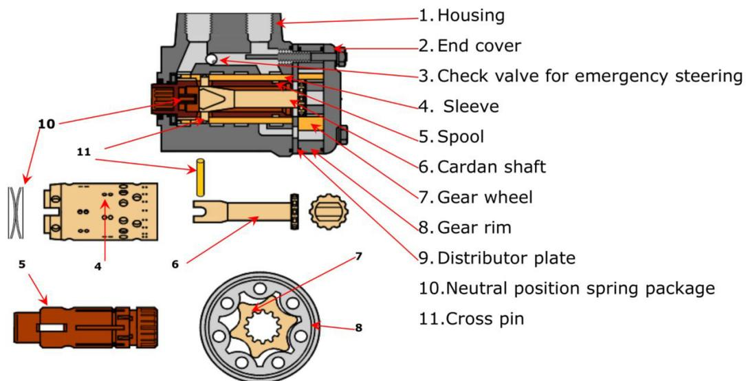
La guida idrostatica agisce tramite cilindri passanti su tutte le ruote in modo preciso e confortevole anche nelle fasi di manovra a veicolo fermo. Conforme alle normative vigenti in materia di sicurezza stradale, lo sterzo controlla i due assi sterzanti applicando al veicolo un raggio minimo di sterzata di 4500 mm consentendo la massima versatilità su strade particolarmente strette e nei centri storici.
